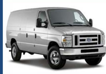
5.4L Dedicated Ford E150, E250, E350 cargo and passenger van (bi-fuel soon)
